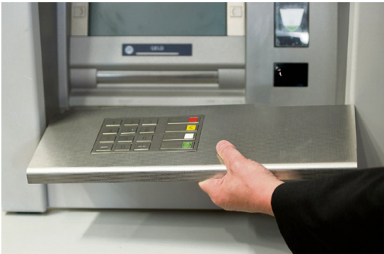
Mit manipulierten Tastaturen können Betrüger PIN-Nummern und Magnetstreifendaten stehlen. Bild: key
